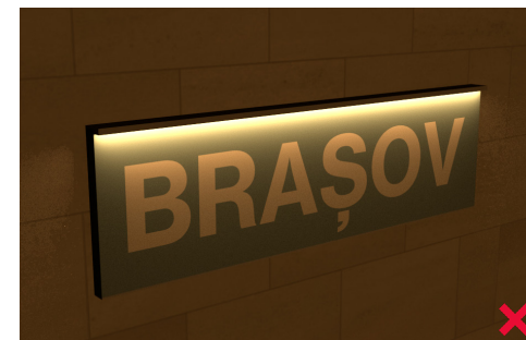
9. Panou- sursă exterioară lumină descendentă
