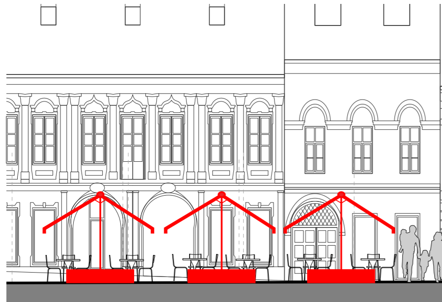
Figura 20. Poziționarea copertinelor individuale cu sprijin lateral - „Așa NU” Sursa imaginii: autorii
